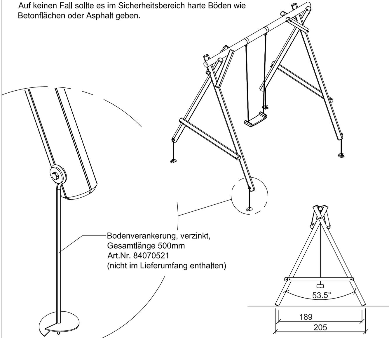
Um ein Umkippen oder Heben der Anlage zu verhindern, müssen die Pfosten an 4 eindrehbare Bodenanker angeschlossen werden (nicht im Lieferumfang enthalten).
